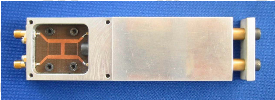
Abbildung 4.14: Aufnahme des Kurzschlusschiebers
