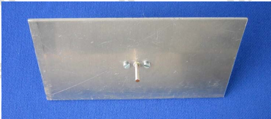
Abbildung 4.30: Aufnahme der \lambda/4 -Stabantenne
